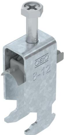
Bride de fixation avec pied H, plaque de pression en matière plastique en polypropylène. Pour montage vertical et horizontal de 2 câbles individuels sur des rails profilés en C. Pour une ouverture de 16 – 17 mm. Avec vis à 1 filet sur plaque de pression, tête de vis hexagonale universelle SW10, avec fente et empreinte cruciforme. Convient au montage en intérieur et en extérieur. Plusieurs câbles doivent être séparés par des plaques doubles. L'utilisation d'une contre-plaque est recommandée.
