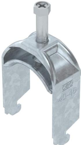
Bride de fixation avec pied N, plaque de pression en métal avec bords arrondis pour la protection des câbles. Pour montage vertical et horizontal d'1 câble individuel sur des rails profilés en C. Pour une ouverture de 11 – 12 mm. Avec vis à 1 filet sur plaque de pression, tête de vis hexagonale universelle SW10, avec fente et empreinte cruciforme. Convient au montage en intérieur et en extérieur. L'utilisation d'une contre-plaque est recommandée.
