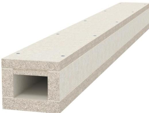
Goulotte coupe-feu en béton léger armé de fibres de verre résistantes à l'eau et au gel de la classe de matériaux A1 selon EN 13501-1 pour l'installation de câbles photovoltaïques à l'intérieur et à l'extérieur des bâtiments. Les exigences en matière de protection contre les contacts accidentels des forces d'intervention sont remplies. Classification I30 comme goulotte I suivant DIN 4102 partie 11 pour la protection des voies d'évacuation et issues de secours.
