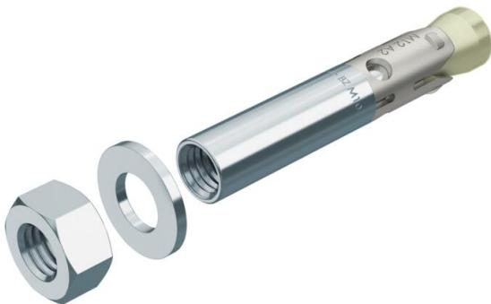
Goujon d'ancrage BZ-IG avec taraudage pour ancrage de charges semi-lourdes et lourdes dans du béton fissuré ou non fissuré. Il associe des charges admissibles élevées à de faibles entraxes et écartements entre les bords. Une contre-dépouille des alésages n'est pas nécessaire.
