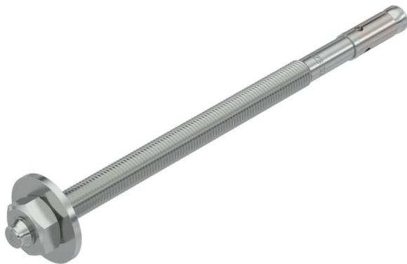
Boulon d'ancrage BZ3 pour ancrage de charges semi-lourdes et lourdes dans du béton fissuré ou non fissuré. Convient pour des charges admissibles élevées à de faibles entraxes et écartements entre les bords. À frapper.
