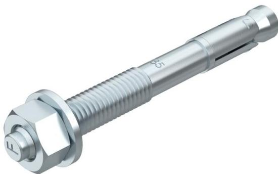
Goujon d'ancrage BZ pour ancrage de charges semi-lourdes et lourdes dans du béton fissuré ou non fissuré. Il associe des charges admissibles élevées à de faibles entraxes et écartements entre les bords.
