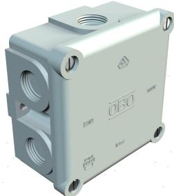
Indice de protection IP54, tension nominale 2,5 - 4 V, section nominale 2,5 - 4 en combinaison avec bornier de raccordement type 700/6 M, le boîtier a une section nominale de 4 mm<sup>2</sup>, 2 trous de montage pour des vis jusqu'à 5 mm Ø sur la face externe du boîtier. 4 vis pour couvercle, 7 entrées défonçables avec filetage M20 x 1,5, de préférence pour presse-étoupes à filetage court
