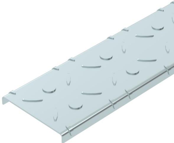
L'épaisseur du couvercle se compose d'une bande de tôle d'acier galvanisée de 2,0 mm d'épaisseur et d'une hauteur d'ondulation de 1,3 mm.
