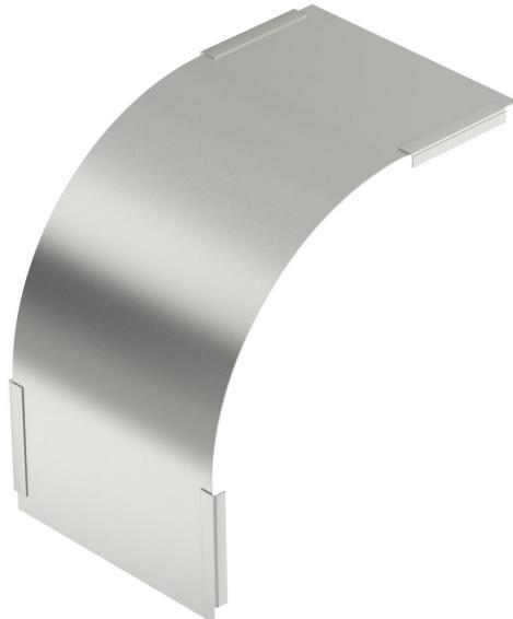
Couvercle pour coudes verticaux convexes d'une hauteur d'aile de 60. Le montage des couvercles s'effectue par insertion dans le chemin de câble. Pour plus de solidité, le couvercle peut être fixé avec des clips de fixation pour couvercle.
