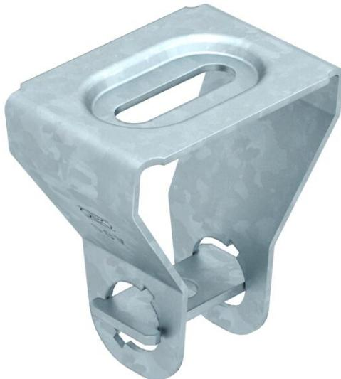
Support de plafond pour la suspension par tiges filetées. La possibilité de réglage variable permet une utilisation universelle. Le logement de tige filetée bloqué offre la possibilité de régler progressivement l'angle.
