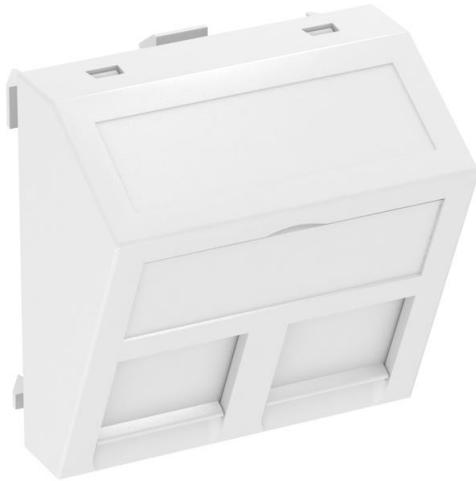
Support informatique avec sortie inclinée et poussoir d'obturation pour le logement de deux noyaux informatiques RJ45. La fixation à encliquer convient pour le montage horizontal et vertical dans l'environnement du système. Le type C présente une ouverture de montage de 19,30 X 14,80 mm et est conçu pour la fixation directe des noyaux informatiques dans l'ouverture de montage.
