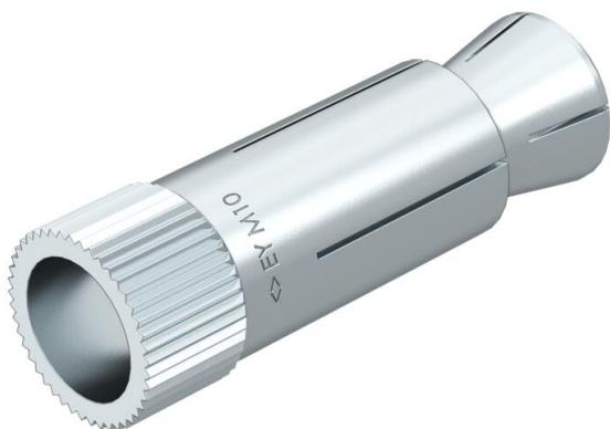
Ancrage pour faux plafond Easy pour le montage dans des panneaux de faux plafond en béton précontraint. Lors du serrage de la vis ou de l'écrou, le cône se détache de la douille d'ancrage et est tiré dans la douille. La cheville s'écarte ainsi dans l'espace vide et génère un blocage par contact mécanique. L'ancrage pour faux plafond peut également être utilisé lorsque la zone d'expansion ne se trouve pas dans un espace vide.
