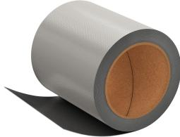
Bobine de protection contre l'incendie à revêtement simple face avec un matériau qui mousse en cas d'incendie pour calfeutrement des installations dans la cloison en mortier PYROMIX® et la cloison en panneaux de fibres PYROPLATE®. Le tissage support est équipé unilatéralement de la couche qui forme l'isolant. L'épaisseur nominale est de 1,5 mm.
