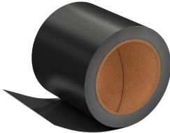
Bobine de protection contre l'incendie à revêtement double face avec un matériau qui mousse en cas d'incendie pour calfeutrement des installations dans la cloison en mortier PYROMIX® et la cloison en panneaux de fibres PYROPLATE®. Le tissage support est équipé des deux côtés de la couche qui forme l'isolant. L'épaisseur nominale est de 1,5 mm.
