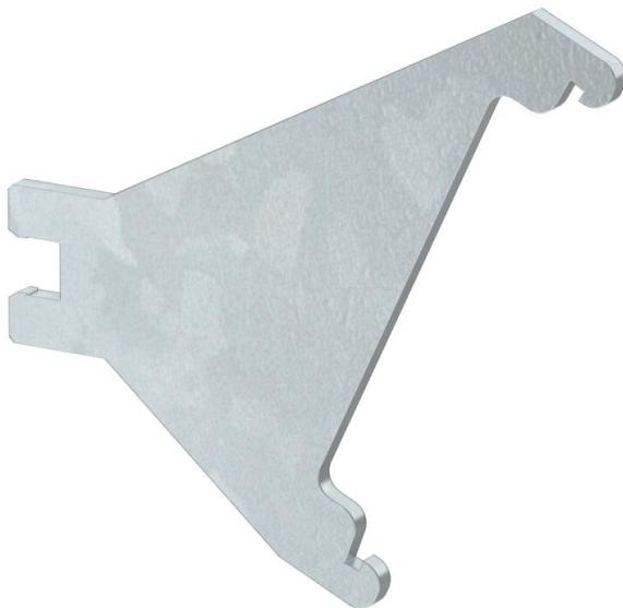
Tôle stabilisatrice pour la stabilisation de l'ouverture système de la goulotte d'appareillages design de la série GAD. La tôle est introduite dans le socle de la goulotte et elle accompagne la pose de couvercle et assure un maintien sécurisé des appareillages.
