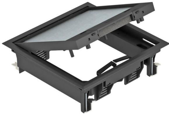
Boîtier de sol avec coulisseau d'arrêt pour 6 appareillages individuels Modul 45 maximum sur 2 supports universels UT3, insertion dans les systèmes de goulottes et dans les faux planchers en intérieur. Évidemment prédefini de 5 mm pour l'insertion du revêtement de sol dans le couvercle rabattable, réglage possible à 3, 8 ou 10 mm si nécessaire.
