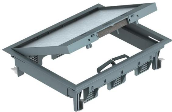
Boîtier de sol avec coulisseau d'arrêt pour 9 appareillages individuels Modul 45 maximum sur 3 supports universels UT3, insertion dans les systèmes de goulottes et dans les faux planchers en intérieur. Évidemment prédefini de 5 mm pour l'insertion du revêtement de sol dans le couvercle rabattable, réglage possible à 3, 8 ou 10 mm si nécessaire.
