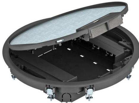
Boîtier de sol GESR9 avec une hauteur de montage fixe de 55 mm en intérieur. Avec deux boîtiers de montage pour le montage vertical d'appareillages Modul 45 et quatre décharges de traction. Pour le montage des appareillages Modul 45, deux cadres de montage sont nécessaires. Le montage des modules de données s'effectue avec une plaque de montage MPMT45 en option. Le boîtier de sol est équipé d'équerres de fixation universelles.
