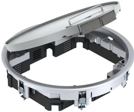
Boîtier de sol avec poignée étrier pour 10 appareillages individuels Modul 45 maximum sur 2 supports universels UT3 et un support universel UT4, insertion dans les systèmes de conduits et les faux plafonds en intérieur.
