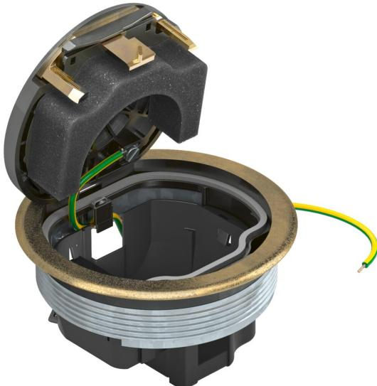
Boîtier de sol rond avec cadre de protection de revêtement de sol pour montage direct dans la boîte de raccordement UDL2-120. À l'état fermé, le boîtier de sol peut être nettoyé à l'eau. La profondeur d'encastrement minimale est de 70 mm.
