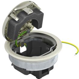
Boîtier de sol rond avec cadre de protection de revêtement de sol pour montage direct dans la boîte de raccordement UDL2-120, à l'intérieur. À l'état fermé, le boîtier de sol peut être nettoyé à l'eau. La profondeur d'encastrement minimale est de 70 mm.
