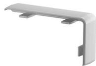
Couvre-joint pour le socle des goulottes d'appareillage Rapid 45-2 afin de dissimuler les bords de coupe et pour un raccordement impeccable des segments de goulottes. Les couvre-joints sont emboîtés sur la goulotte. Convient aux largeurs de goulotte de 100 mm et de 165 mm.
