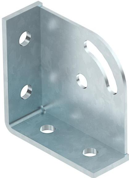
Équerre 90° renforcée 6 trous pour le raccordement de rails profilés 41 x 41 mm et 41 x 21 mm. Possibilité supplémentaire de fixer une jambe de force à un angle de 45° avec une possibilité de réglage de +/- 30°. Pour des équerres de 15° à 75°.
