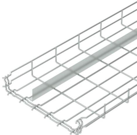
Chemin de câbles en treillis avec raccord préformé et séparateur soudé d'une hauteur d'aile de 55 mm.
