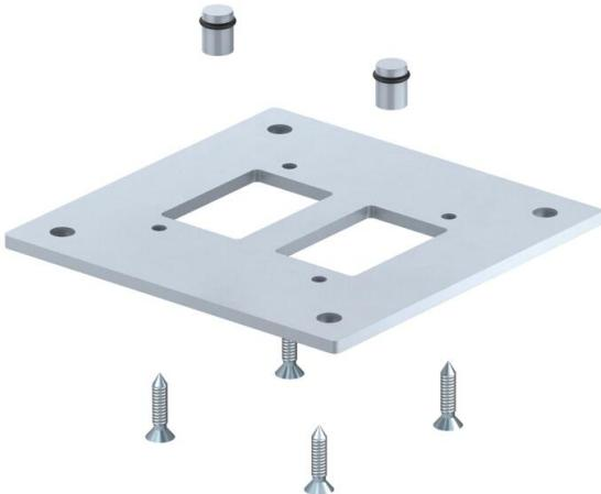
Plaque de sol pour la fixation de la colonne industrielle au sol. Sont inclus dans les fournitures 4 vis de fixation pour montage de la plaque de sol sur profil de colonne et 2 bouchons étanches pour une fermeture étanche à l'air des goulottes pour air comprimé.
