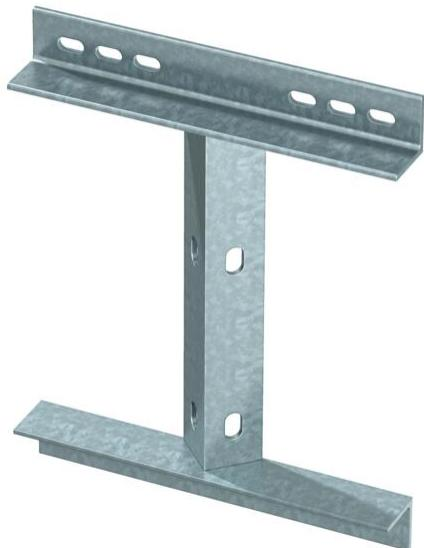
Plaque d'adaptation avec trous oblongs pour fixation universelle sur poutres métalliques verticales (IPN) et sur murs. Des consoles murales à talon sont vissées sur la plaque d'adaptation à un angle de 45°. Pour le supportage des chemins de câbles dans les angles de bâtiment et passages particuliers. Pour le montage de la console sur la plaque d'adaptation, utiliser la vis à tête hexagonale type SKS 12x40 GF. Merci de commander ces articles séparément.
