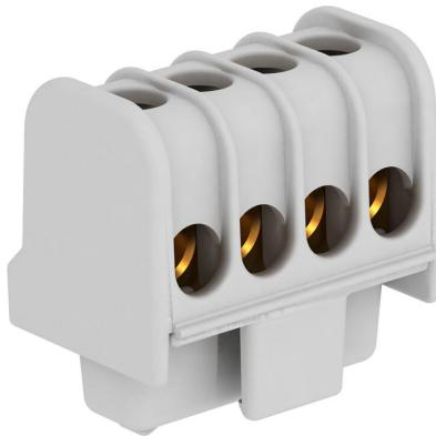
Bornes en laiton, vis en acier, galvanisées (passivation transparente), section nominale 6 ÷ 16 mm<sup>2</sup>, tension nominale 400 V, 1 pôle, avec bornes à douilles max. Conducteurs raccordables par borne max. 4x16mm<sup>2</sup>, 4x10mm<sup>2</sup>, 8x6mm<sup>2</sup> et 12x4mm<sup>2</sup>.
