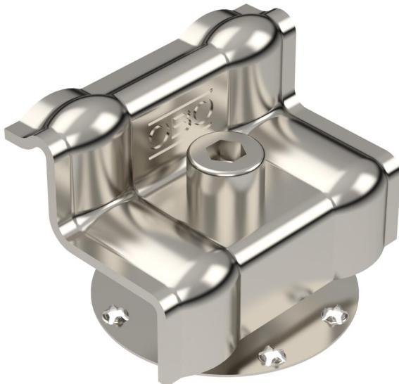
Borne embout à ressort pour la fixation de modules photovoltaïques sur les profilés porteurs. Convient pour une ouverture de 10 mm. Fixation visable du module PV avec une clé Allen taille 6.
