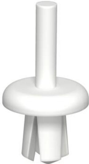
Pour un montage rapide et un fonctionnement optimal, utiliser l'outil de rivetage KNW1. Cote du trou de perçage : 4,5 mm.
