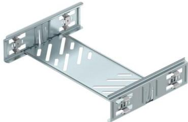
Kit d'éclisses rapides avec fixation rapide pour les éclissages sans vis de chemins de câbles perforés d'une hauteur d'aile de 60 mm. Grâce à une forme de construction optimisée, l'éclisse peut être utilisée pour réaliser des rayons et pour combler les longueurs quand l'installation est exposée aux grandes variations de température.
