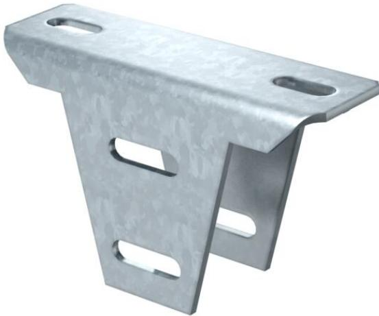
Plaque de tête variable pour le montage sur des montants US 5. En association avec le montant US 5, toutes les longueurs de pendards peuvent être fabriquées sur place. Avec la plaque de tête variable, il est possible de compenser les suspensions inclinées jusqu'à 30°.
