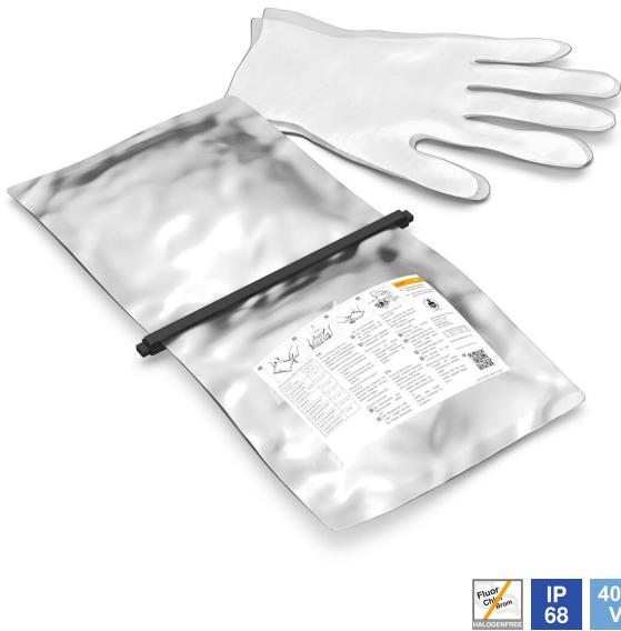
Masse de scellement Aquasit à deux composants dans un sachet en aluminium veillant au remplissage des boîtes de dérivation de câbles pour les applications extérieures présentant une humidité extrêmement élevée et prolongée. Également utilisable en cas de choc mécanique.
