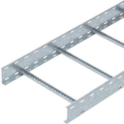
Échelle à câbles d'une hauteur d'aile de 110 mm avec échelons soudés à profilé C30 ouvert vers le haut. Longeron latéral enroulé pour le renforcement et la protection des bords. La fixation sur console s'effectue avec des pièces de serrage de type LKS 40. La fente de l'échelon mesure 16,5 mm. La bride de fixation correspondante est de type 2056.
