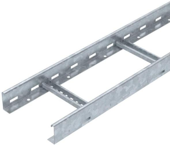
Échelle à câbles d'une hauteur latérale de 60 mm avec échelons soudés à profilé C30 ouvert vers le haut. Longeron latéral enroulé pour le renforcement et la protection des bords. La fixation sur console s'effectue avec des pièces de serrage de type LKS 40. La fente de l'échelon mesure 16,5 mm. La bride de fixation correspondante est de type BS-H....
