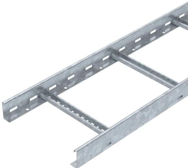
Échelle à câbles d'une hauteur latérale de 60 mm avec échelons soudés à profilé C30 ouvert vers le haut. Longerons latéraux enroulés pour le renforcement et la protection des bords. La fixation sur console s'effectue avec des pièces de serrage de type LKS 40. La fente de l'échelon mesure 16,5 mm. La bride de fixation correspondante est de type BS-H....
