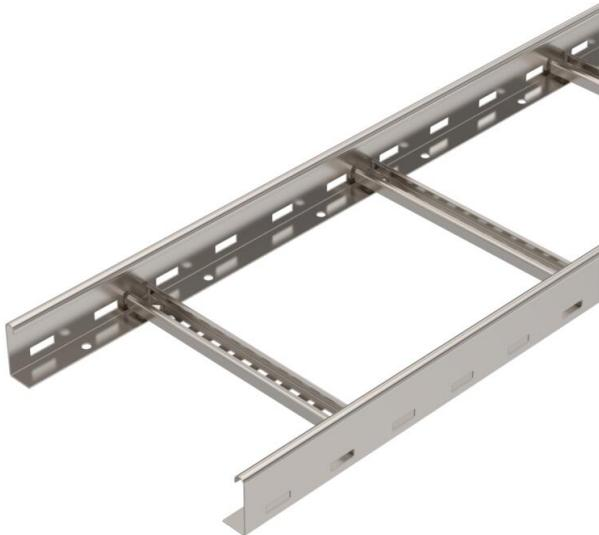
Échelle à câbles d'une hauteur d'aile de 60 mm avec échelons soudés à profilé C30 ouvert vers le haut. Longerons latéraux enroulés pour le renforcement et la protection des bords. La fixation sur console s'effectue avec des pièces de serrage de type LKS 40. La fente de l'échelon mesure 16,5 mm. La bride de fixation correspondante est de type 2056.
