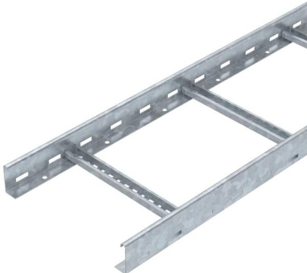
Échelle à câbles d'une hauteur latérale de 60 mm avec échelons soudés à profilé C30 ouvert vers le haut. Longerons latéraux enroulés pour le renforcement et la protection des bords. La fixation sur console s'effectue avec des pièces de serrage de type LKS 40. La fente de l'échelon mesure 16,5 mm. La bride de fixation correspondante est de type 2056.
