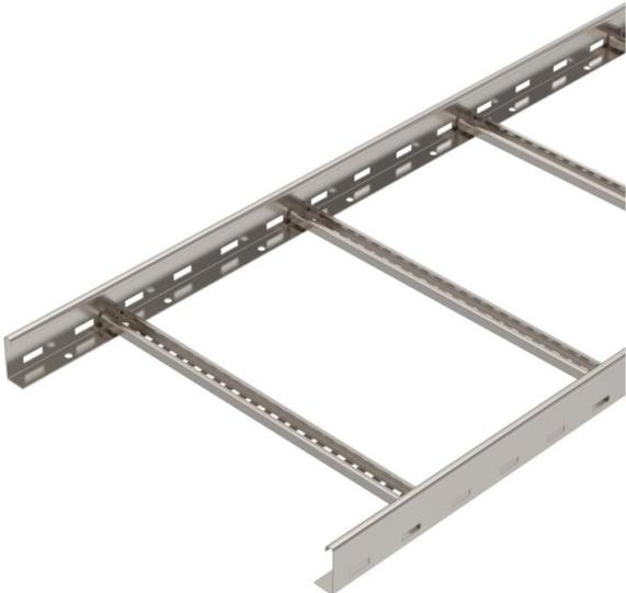
Échelle à câbles d'une hauteur latérale de 60 mm avec échelons soudés à profilé C30 ouvert vers le haut. Longerons latéraux enroulés pour le renforcement et la protection des bords. La fixation sur console s'effectue avec des pièces de serrage de type LKS 40. La fente de l'échelon mesure 16,5 mm. La bride de fixation correspondante est de type 2056.
