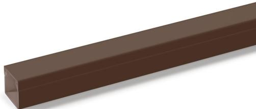
Goulotte de distribution LE pour la distribution encastrée des câbles à l'intérieur. Socle de goulotte avec fond perforé pour le montage. Difficilement inflammable et auto-extinguible après retrait d'une flamme ardente. Effectuer des changements de direction avec les pièces de forme et obturer les extrémités de goulotte à l'aide des embouts. Testé selon DIN EN 50085-1 et DIN EN 50085-2-1. Socle et couvercle dans le set.
