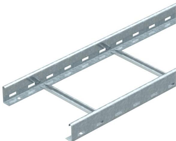
Echelle à câbles avec longeron latéral perforé d'une hauteur d'aile de 60 mm, avec échelons NS rivetés (profilé en C) ouverts vers le haut.
