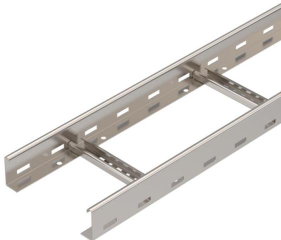
Echelle à câbles avec longeron latéral perforé d'une hauteur d'aile de 60 mm, avec échelons NS rivetés (profilé en C) ouverts vers le haut. L'échelle à câbles est livrée repliée.
