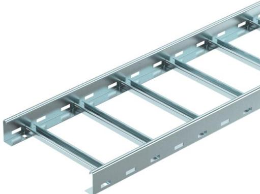
Échelle de câbles pour la pose horizontale de câbles et de conduits. Peut être employé comme structure porteuse normalisée pour le maintien de fonction selon DIN 4102 partie 12 Classes de maintien en fonction E30 à E90. Avec un échelon profilé en C riveté et ouvert en haut.
