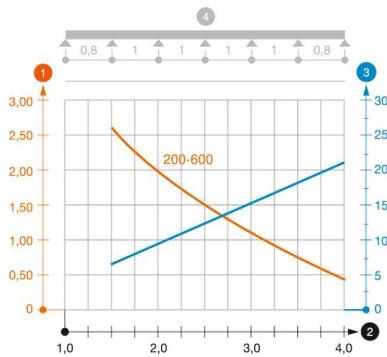
Diagramme de charge échelle à câbles type LG 60 NS
