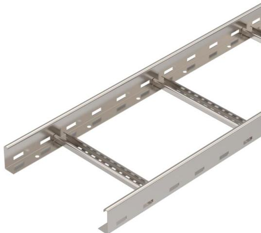
Echelle à câbles avec longeron latéral perforé d'une hauteur d'aile de 60 mm, avec échelons NS rivetés (profilé en C) ouverts vers le haut. L'échelle à câbles est livrée repliée.
