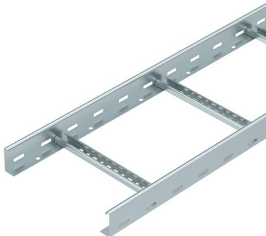
Echelle à câbles avec longeron latéral perforé d'une hauteur d'aile de 60 mm, avec échelons NS rivetés (profilé en C) ouverts vers le haut.
