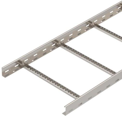
Echelle à câbles avec longeron latéral perforé d'une hauteur d'aile de 60 mm, avec échelons NS rivetés (profilé en C) ouverts vers le haut. L'échelle à câbles est livrée repliée.
