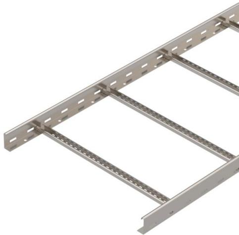
Echelle à câbles avec longeron latéral perforé d'une hauteur d'aile de 60 mm, avec échelons NS rivetés (profilé en C) ouverts vers le haut. L'échelle à câbles est livrée repliée.
