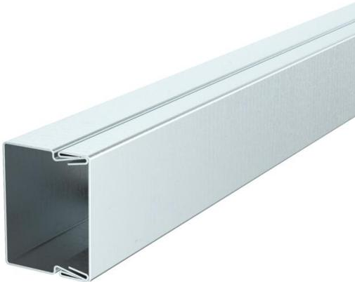
Parties supérieure et inférieure de goulotte avec fond perforé La liaison équipo-tentielle est assurée sans accessoire supplémentaire entre le couvercle et le socle. La goulotte de distribution LKM de type LKM 20030 a été testée comme système de pose pour le maintien en fonction selon DIN 4102 partie 12. Veuillez prendre en considération les types de câbles testés destinés au domaine des systèmes de protection anti-incendie BSS.
