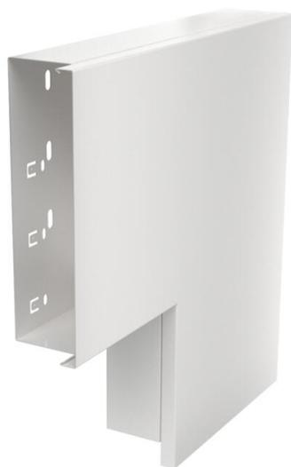
Angle plat avec couvercle pour un changement de direction des goulottes LKM. Liaison équipotentielle assurée sans autre accessoire, entre la partie supérieure et inférieure.
