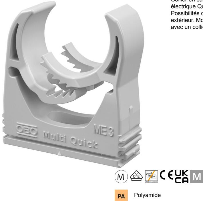
Collier en saillie pour la fixation de tubes métriques et de tubes d'installation électrique Quick-Pipe. Plage de serrage flexible de plusieurs millimètres. Possibilités de fixation universelles au mur et au plafond, en intérieur comme en extérieur. Montage de tubes sans outils. Peuvent être reliés en série, également avec un collier OBO Quick ou starQuick.
